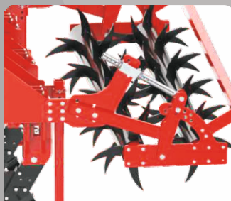
Regolazione dell'altezza del rullo posteriore
