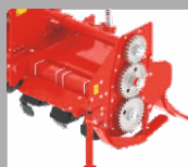
Trasmissione laterale a ingranaggi per carichi pesanti con larghezza extra
