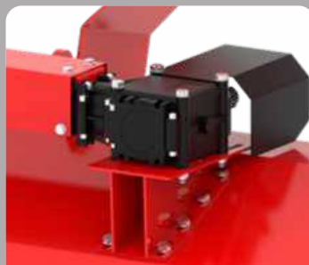
Riduttore con ruota libera 540 giri/min
